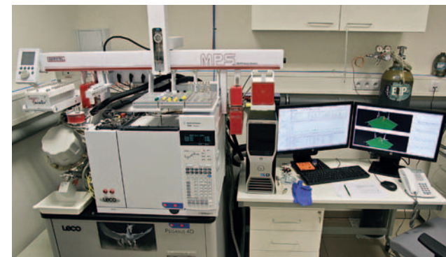
Takzvaný dvojdimenzionální plynový chromatograf, spojený s hmotnostním spektrometrem. Moderní přístroj, který dokáže analyzovat stovky až tisíce chemických látek v jediném rostlinném vzorku.
