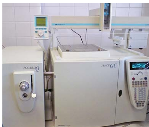
Hmotnostní spektrometr spojený s plynovým chromatografem (vlevo) a s kapalinovým chromatografem (vpravo)
