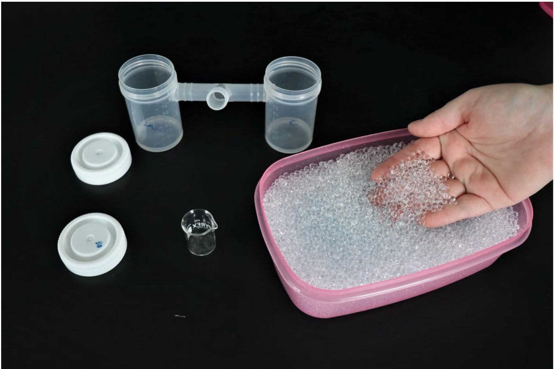
Prolézačka připravená na pokus. Prolézačka se skládá ze dvou nádobek spojených T-spojku.
